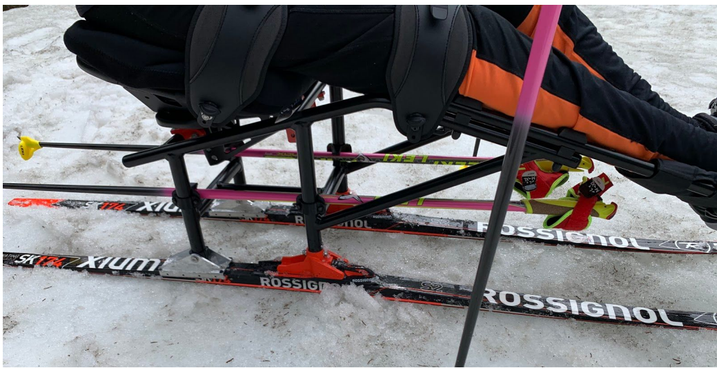
Figur 3.5a - Spesialtilpasset feste for reservestav
