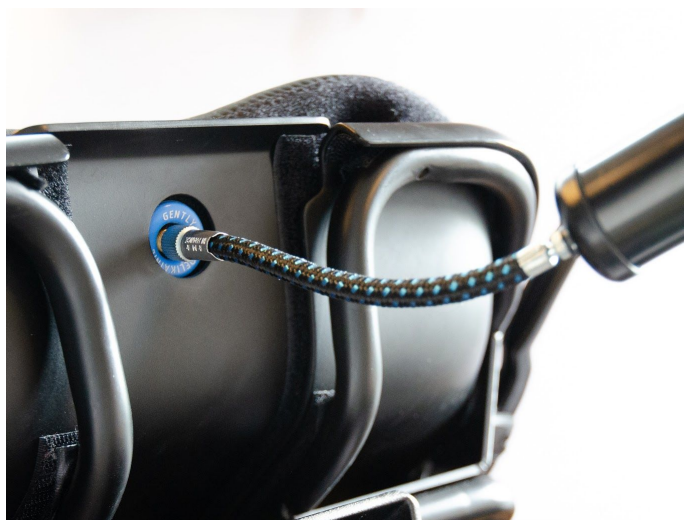
Figur 3.2.1e.3 - Pumpe og adapter montert for tapping av luft
