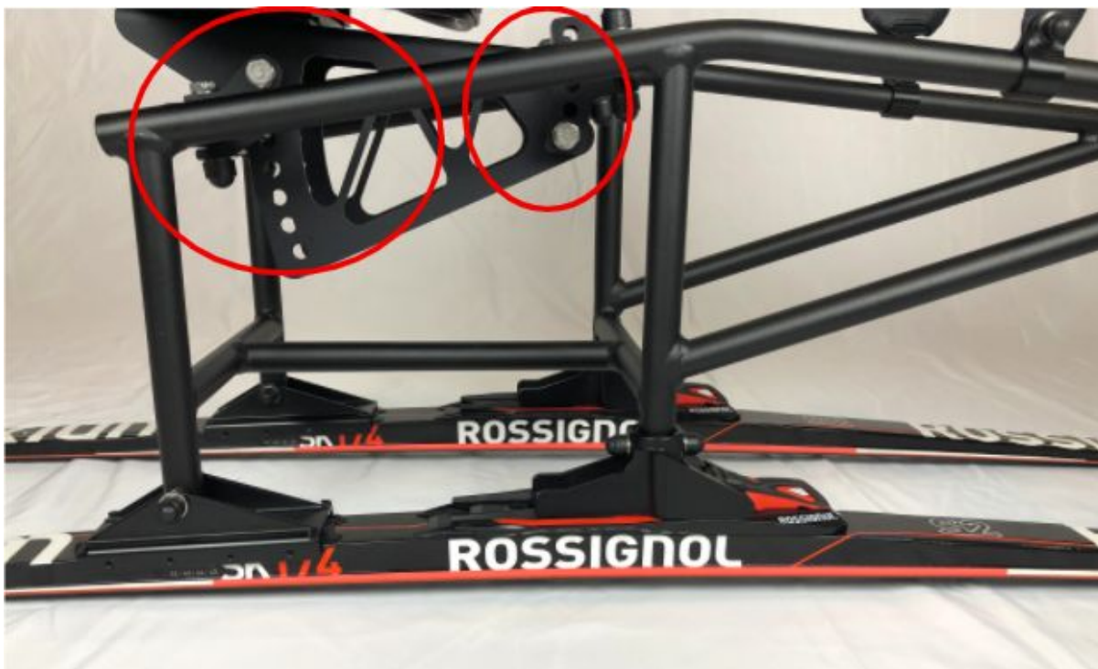
Figur 6.4a - Klemfare ved setearm markert med røde sirkler. Setevinkel og høyde i nedre posisjon.
