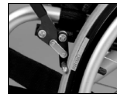
Fig. 44 Bremsen trykker korrekt på dækket
