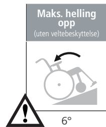
Stolen kan velte hvis hellingen bakover er større enn 6°. Bruk veltebeskyttelse!
