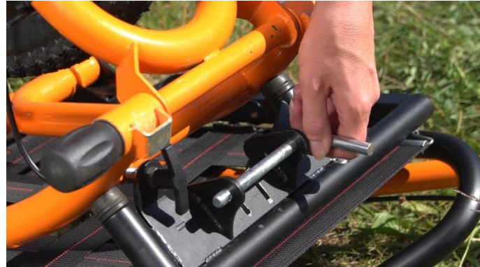
4- Fjern låsesplinten og ta ut låsepinne til fothviler
