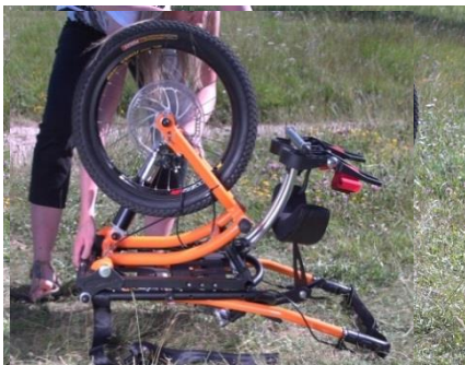
7- putt låsepinnen på plass. Husk låse splinten.
