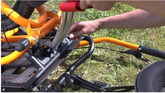
7- putt låsepinnen på plass. Husk låse splinten.
