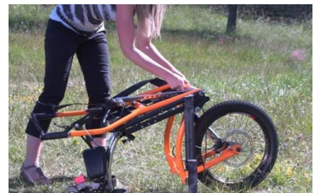
9- Snu Joeletten og plasser den på støttene sine
