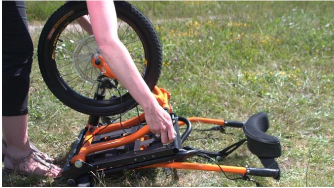
3- Sett låsepinnen inn igjen og sett på plass splinten
