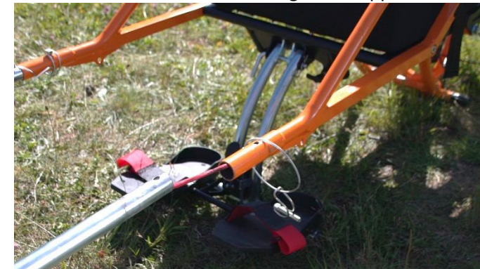
16- Fold ut trekkarmene og fest med låsebolt
