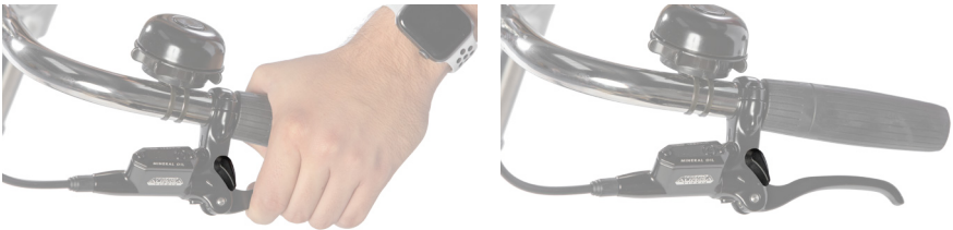
Fig. 1: Parkeringsbremsebryter Trekk i håndtaket og vri på bryteren for å koble parkeringsbremsen inn/ut
