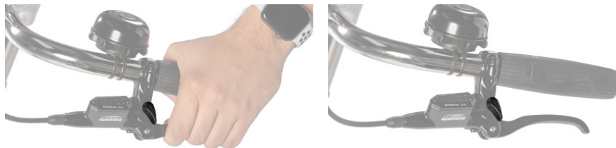
Fig. 2: Parkeringsbremsebryter Trekk i håndtaket og vri på bryteren for å koble parkeringsbremsen inn/ut
