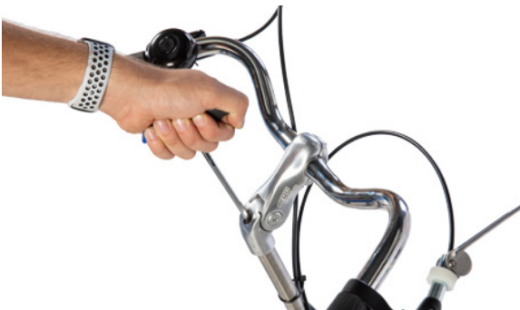
Fig. 8: Skru opp bolten med en skiftenøkkel
