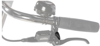
Fig. 1 Parkeringsbremsehendel Flytt denne hendelen for å koble parkeringsbremsen inn/ut
