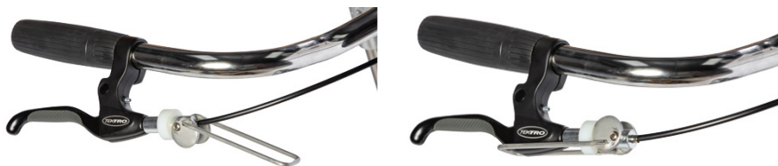
Fig. 1 Parkeringsbremsehendel Flytt denne hendelen for å koble parkeringsbremsen inn/ut
