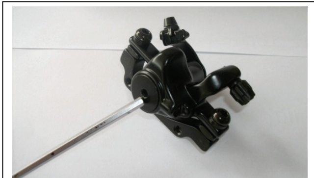
Bremseflensjustering med unbrako 5 mm
