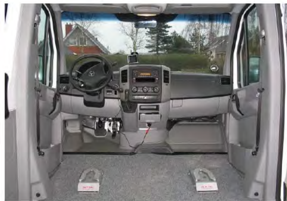
Dahl dokking montert i gulvet til en bil
