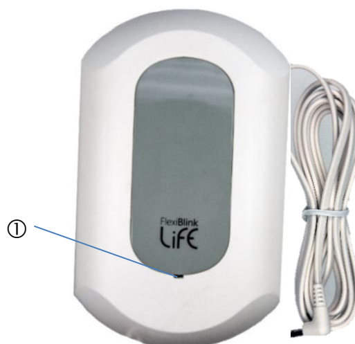
Sengevibrator med tilkoblet ledning for vekkerklokke og strømforsyning
