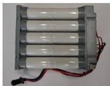
NiMH-batteri (6 kg) og lader
