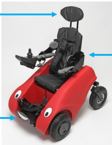
Sittesystem (7,4 kg inkl. hodestøtte, kontroller, seler og puter)
