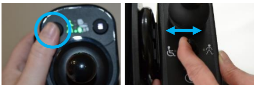
Fig. 52 Bytt mellom bruk av barn og voksen ved å trykke på av/på-knappen på (for en LiNX, LiNX Plus eller DX) eller vippe bryteren på voksenkontrollen (for en Shark eller tidligere versjon av DX)
