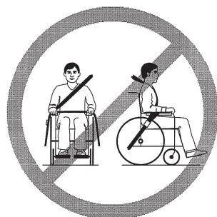
Feil bruk av belte
