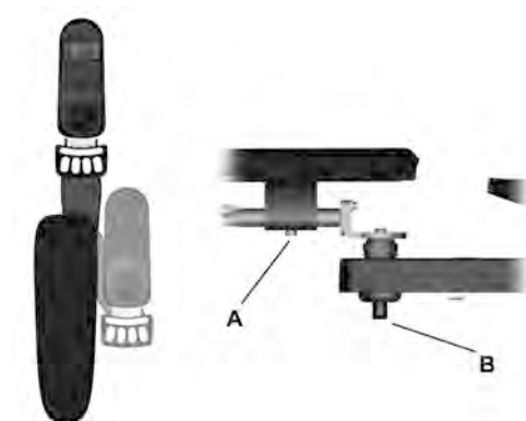
Billede 32. Justere posisjonen til panelholderen.
