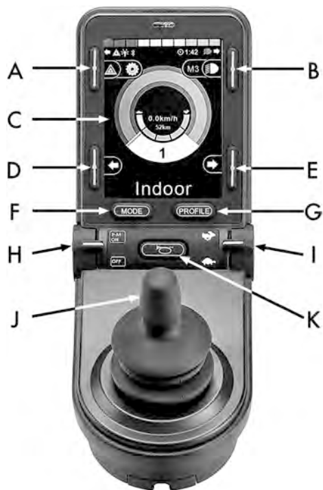
Billede 41 . Oversikt over kontrollpanel.
