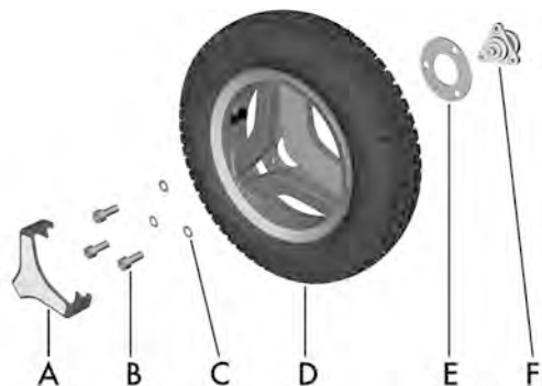
Billede 151. Montering av drivhjulet.
