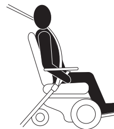
Billede 145. Figurene til venstre viser riktig posisjonering av setebeltet.
