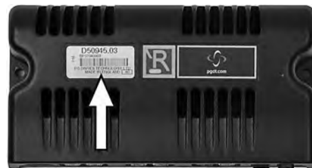
Billede 148. ID-nummer for R-net-strømodul.
