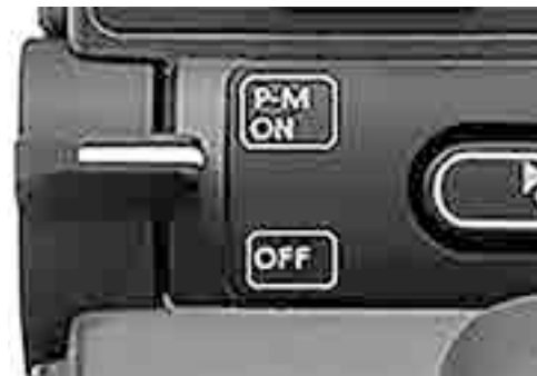
Bilde 46. Vippebryter for strøm, modus og profil.
