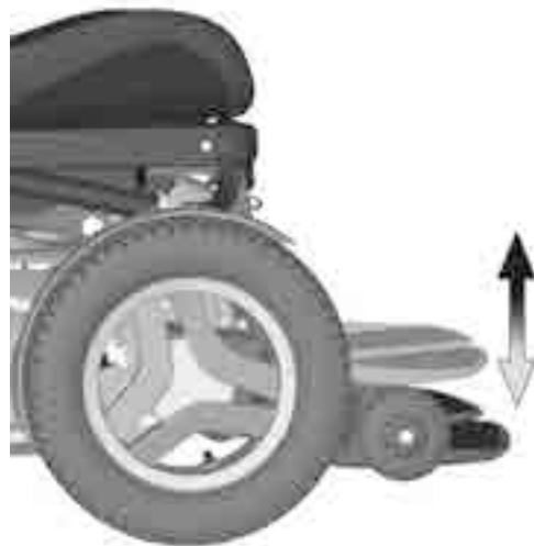
Billede 16. Elektrisk justerbar beinlengde.
