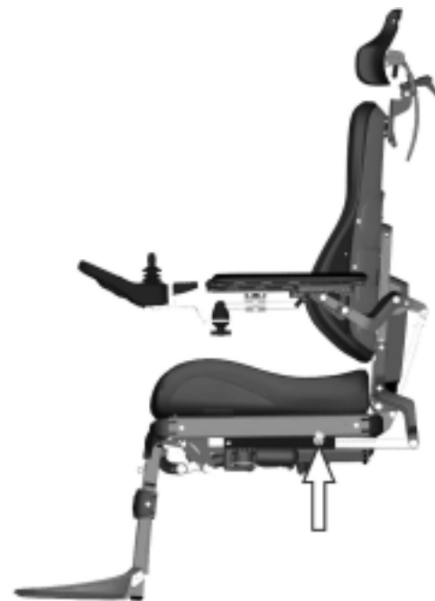
Billede 17. Manuell låsestang for ryggvinkling.
