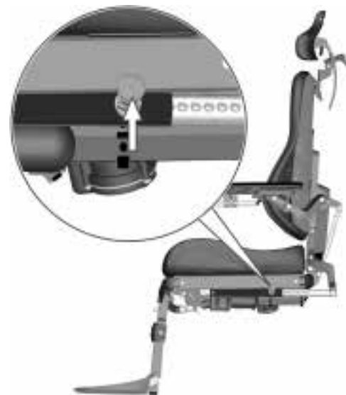
Billede 19. Manuell justering av ryggstøttevinkel.
