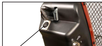
Ladestik forbindes til 3-polet stik på styrcammen. Ladestikket er plassert under beskyttelsespladen.
