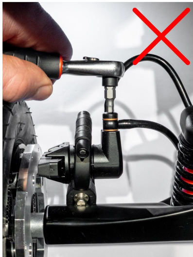
Figur 6.3 - NB! Ikke juster denne skruen. Justering av denne skruen kan føre til lekkasje
