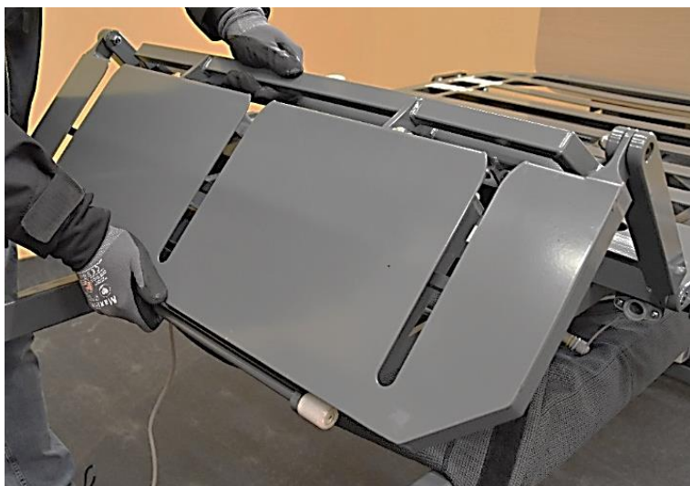
Bandelens nylonhjul løftes ud af u-profilen
