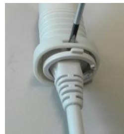
Afmontering af kabellås ved hjælp af flad skruetrækker
