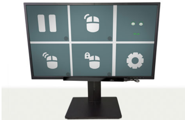
myGaze Power (Assistive 3) montert på PC skjerm
