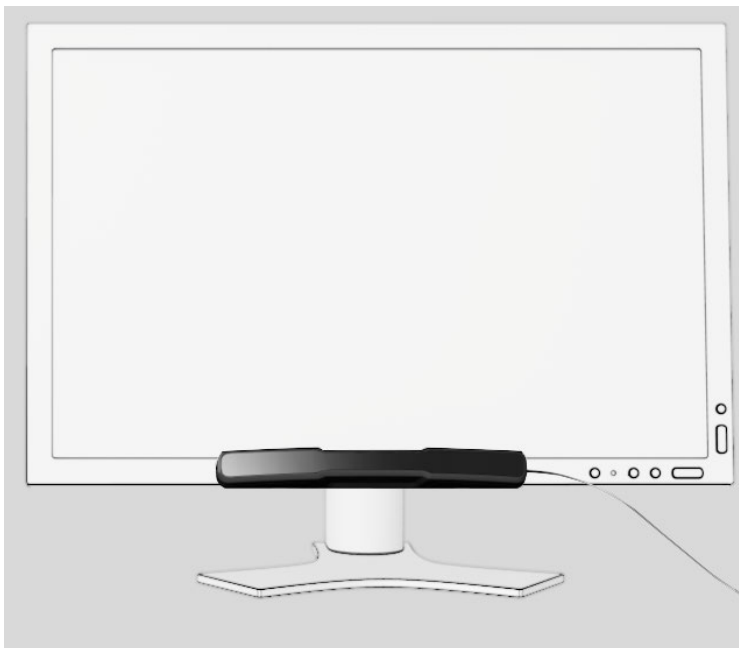
Fullført montering av myGaze Assistive system (Assistive 2) på PC Monitor
