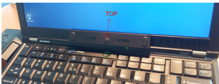
Vinkelbeslag montert på metallstripen ved hengselområdet på bærbar PC
