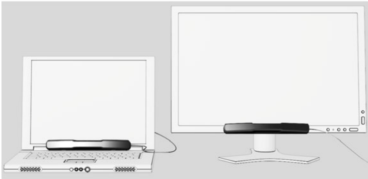
myGaze Assistive system monteret på bærbar PC (venstre) eller skjerm (høyre)
