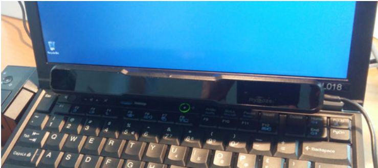
Fullført montering av myGaze Assistive system på en bærbar PC
