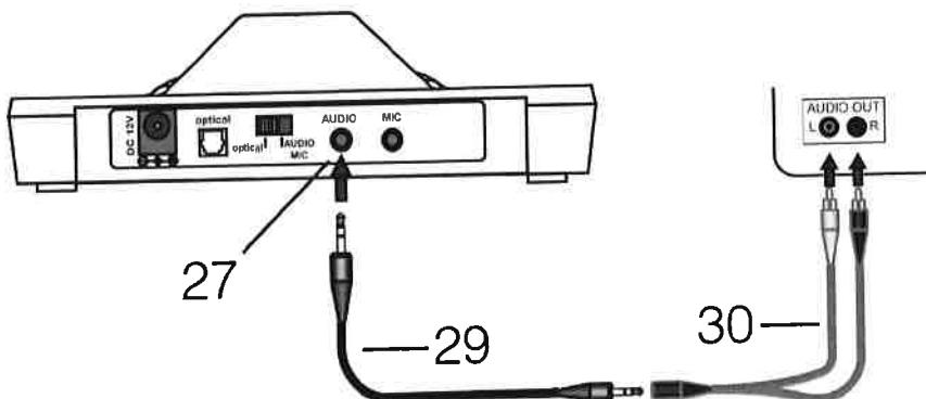
Plugg den medfølgende audio-kabelen **29** inn i den grønne AUDIO-tilkoblingen **27** på Swing IR senderen. Koble den medfølgende adapter-kabelen med RCA/Phono kontakt **30** i audio-kabelen **29**. Finn deretter lydkildens RCA/Phono lydutgang. Koble hvit plugg til hvit kontakt, og rød pugg til rød kontakt. Merk at bryteren **26** på Swing IR senderen står på AUDIO/MIC
