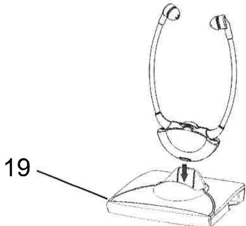
Etter bruk setter du mottakeren tilbake i laderen uten å bruke kraft. Pass på at den sitter korrekt. Når mottakeren lades opp blinker rød LED 18 på venstre side av mottakeren. Så snart batteriet i mottakeren er ladet opp, lyser LED 18 grønt.
