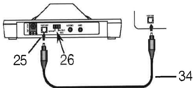
Fjern beskyttelseshettene på den medfølgende Optiske kabelen 34. Koble kabelen til kontakten merket «OPTICAL» 25 på Swing IR senderen. Lokaliser den Optiske tilkoblingen på din lydkilde, å koble kabelen til denne. Pluggen i hver ende av den Optiske kabelen har én flat side. Ikke bruk makt når denne skal plugges inn i den Optiske kontakten, men vri eventuelt pluggen rundt til den går lett på plass. Merk at bryteren 26 på Swing IR senderen står på OPTICAL.
