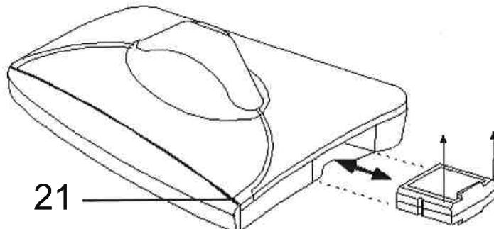
Du kan lade et ekstra batteri i senderen. Ekstra batterier fås kjøpt i faghandelen.
