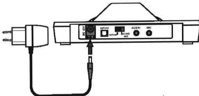
Bruk den medfølgende strømadapter og koble denne til kontakten merket «DC12V» på Swing IR senderen. Selve nettdelen setter du i en stikkontakt.
