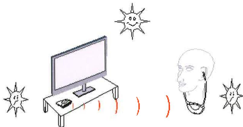
Sett senderen på et egnet sted i nærheten av lydkilden. Det må være fri sikt mellom senderen og mottakeren. Infrarød-mottaks-diodene i mottakeren må alltid være rettet inn mot infrarød-sende-diodene på senderen.
