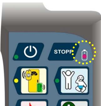
Når lyset i batterisymbolet
