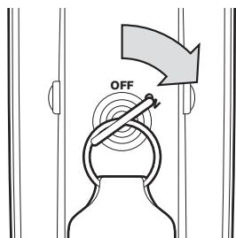
Trappeheisen og ledsagerkontrollene vil ikke fungere hvis du ikke har slått på nøkkelbryteren eller på-/avbryteren.
