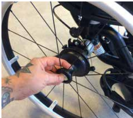
Fig. 11 Demontering/montering av hjul og nedlegging av rygg
