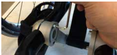
Fig. 02a Høyden på fotbrettene justeres ved å løsne 4 skruer
