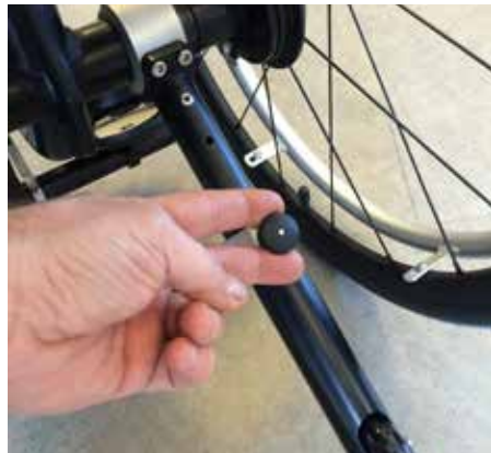
Fig. 09d Endre tippvinkel – dra ut plunger og skyv til indre aktiverte posisjon
