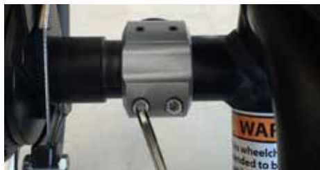
Fig. 10 Justering av avstand mellom hjul
