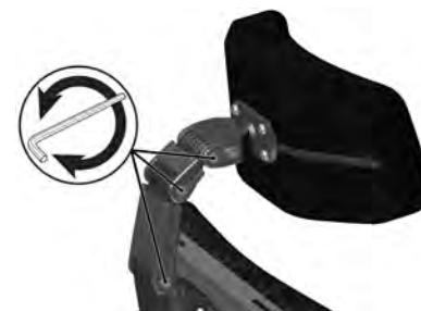
Billede 34. Juster høyde/dybde.
