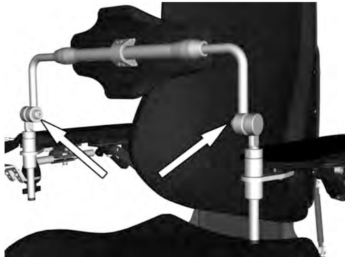
Billede 29. Høyden på bryststøtten sikres med to skruer.
