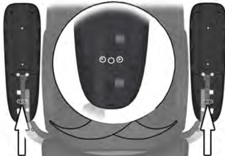
Billede 24. Du stiller inn endepunktene ved å flytte en eller to skruer mellom de tre ulike posisjonene under armstøtten.
