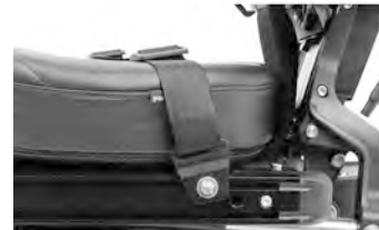
Billede 17. Montert belte, venstre side.
