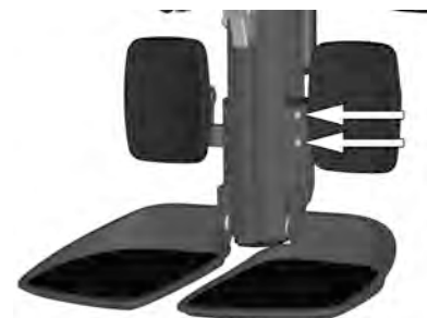
Billede 18. Høyden på fotplatene sikres med to skruer i hver.
