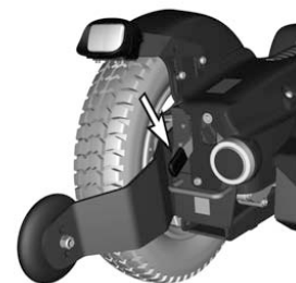
Billede 86. Bremsefrigjøringsspak med sikkerhetssperre
