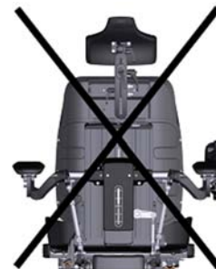
Billede 89. Rullestolen må IKKE sikres ved å feste den til noen deler av setet.
