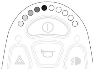
Billede 79. "Vandrende" lysdioder.
