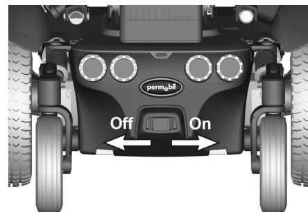
Billede 120. Tilbakestilling av hovedsikring/batterifrakopler.
