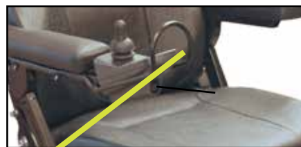
Ladestik forbindes til 3-polet stik på styrstammen. Ladestikket er plassert under beskyttelsespladen.
