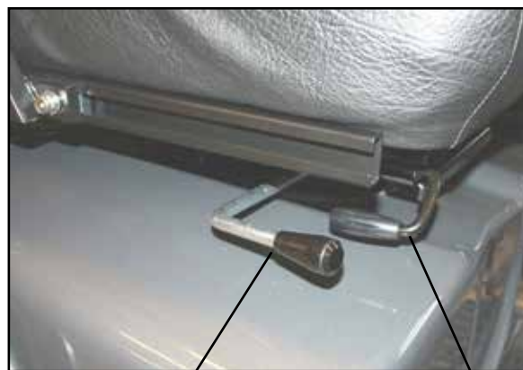
Utløserhåndtak for setedreining. Utløserhåndtak for sete frem/tilbake.
