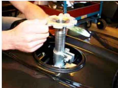
Juster setestolpen til ønsket posisjon. Setestolpen er markert med en ring, for hver cm.
