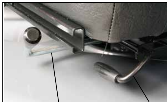
Utløserhåndtak for setedreining. Utløserhåndtak for sete frem/tilbake.
