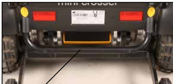
Serienummerskiltets plassering på kjøretøyet.
