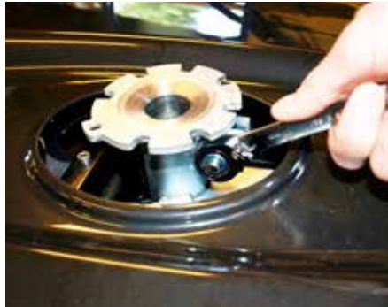
Skru løs låsemutter. Bruk fastnøkkel 17 mm.
