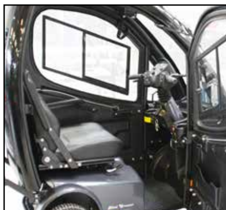
Slå av Mini Crosser, vipp styrestammen opp, dreii setet og vipp armlenet opp.
