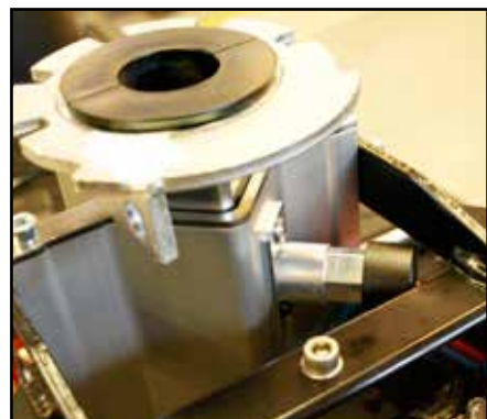
Utløseren trukket ut. Drei den rundt for å få den til å "hoppe" inn igjen.
