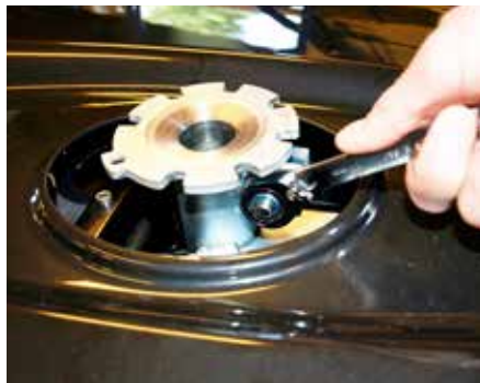
Skru løs låsemutter. Bruk fastnøkkel 17 mm.
