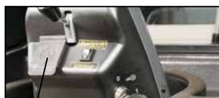
Ladestik forbindes til 3-polet stik på styrstammen. Ladestikket er plassert under beskyttelsespladen.
