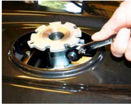
Skru løs låsemutter. Bruk fastnøkkel 17 mm.
