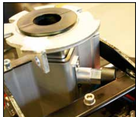
Seteutløseren er trykket ut. Nå kan seterøret løftes eller senkes til ønsket høyde. Trykk utløseren inn slik at den festes i et av de fem hullene på seterøret.
