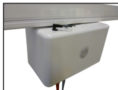
Bilde 5; Kabelen fra kjørevognen kobles inn
