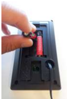
Bilde 14. Bytte av batteri – steg 2
