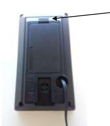
Bilde 13. Bytte av batteri – steg 1
