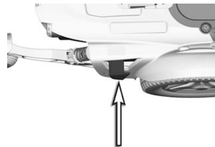
Billede 126. Tilbakestilling av frikopledede bremsler
