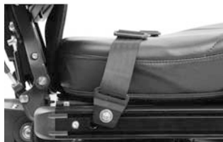
Billede 15. Montert belte, høyre side.
