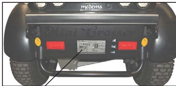
Serienummerskiltets plassering på kjøretøyet.
