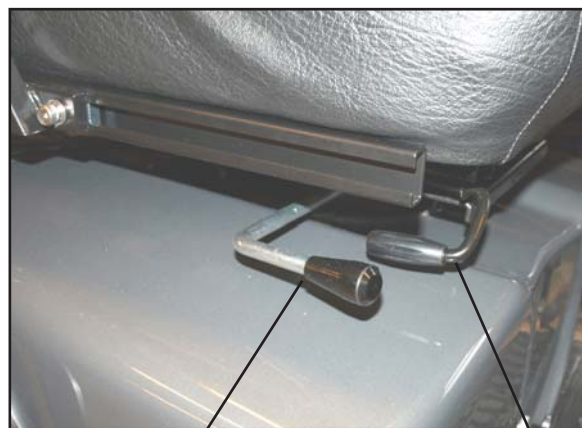
Utløserhåndtak for setedreining. Utløserhåndtak for sete frem/tilbake.
